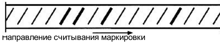
Рисунок 2 - Пример прокатной маркировки предприятия-изготовителя под номером 14
